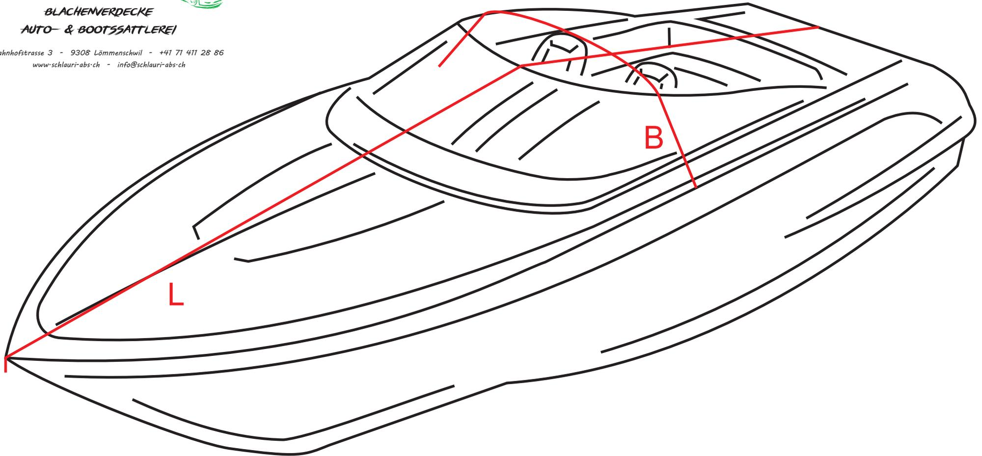
**Länge L:** gemessen von Scheuerleiste Bug bis Scheuerleiste Heck oder Kante Badeplattform über grösste Höhe
